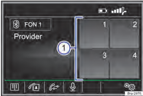
Fig. 137 The telephone main menu.
